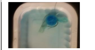
Abb.: 6 Das gefärbte Wasser wandert durch die Wursthaut in die Salzlösung
