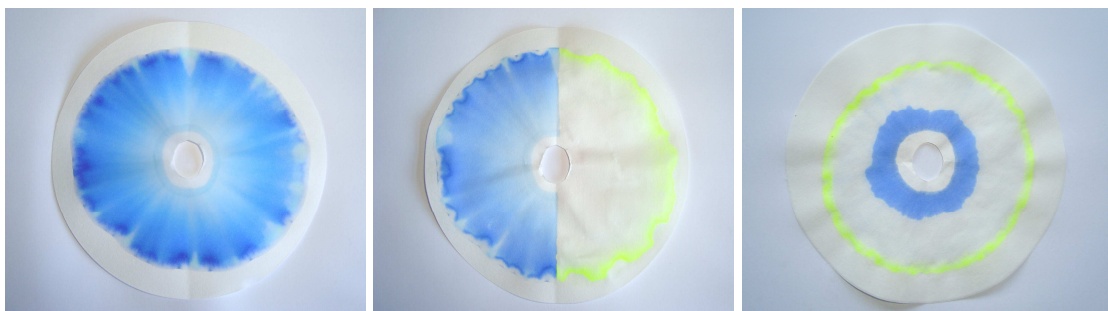
Abb.: Chromatogramme auf Whatman- (links und Mitte) sowie auf Rotalibo-Filterpapier
