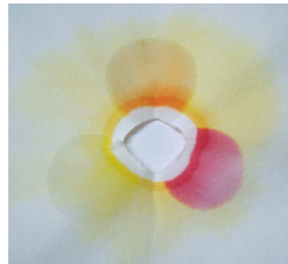
Abb.: Ausschnitt aus dem Papierchromatogramm des grünen Herlitz-Stiftes mit aufgetropften Pufferlösungen (links pH 7-, Mitte pH 8- und rechts pH 9-Pufferlösung)
